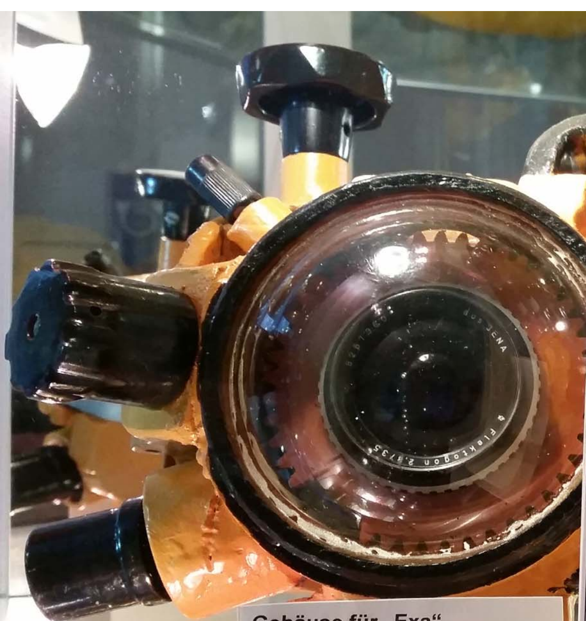
Gehäuse für „Exa“ Eigenbau: Dr. Martin Rauschert 1959 Material PVC, geklebt mit Anschluss für Elektronenblitz Kalotte aus Plexiglas
