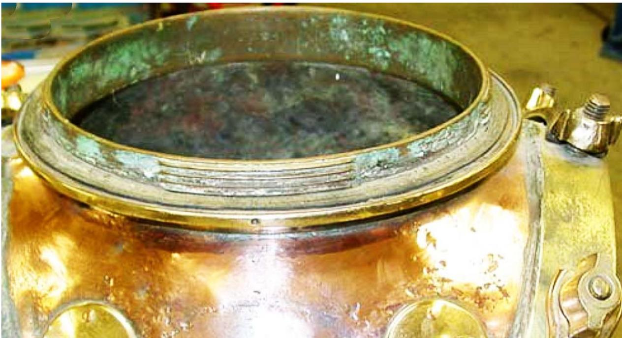
Das unterbrochene Gewinde zum Aufstecken/Aufschauben des Helmes
