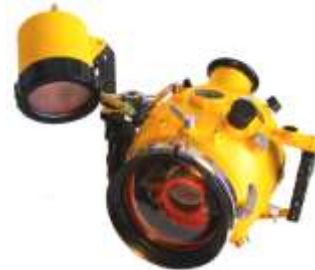
Gehäuse mit „Exa 1a“ Eigenbau: Dr. Martin Rauschert um 1964 Material: Messing gedrückt.
