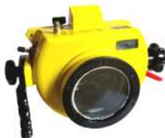
Gehäuse mit „Exa 1b“ Eigenbau: Uwe Mattern 1968/71 Elektronenblitz mit 2 Reflektoren Schaltung: nach G. Schumann (Magdeburg) Leistung: 120 WS Pilotleuchte Material: PVC, geklebt
