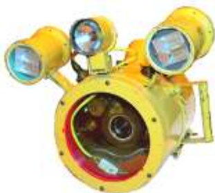
Gehäuse mit „Exa 1b“ Eigenbau: Uwe Mattern 1968/71 Elektronenblitz mit 2 Reflektoren Schaltung: nach G. Schumann (Magdeburg) Leistung: 120 WS Pilotleuchte Material: PVC, geklebt
