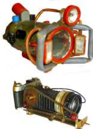
Gehäuse mit „Exa“ Eigenbau: Dr. Martin Rauschert um 1962 Spezialgehäuse für Nah- und Makroaufnahmen, Material PVC, geklebt, mit Führungs- und Aufhellblitz sowie Suchlampe Umrüstung mit Balgennaheinstellvorrichtung und Praktisix-Objektiv „Biometar 2.8/80 Carl Zeiss Jena
