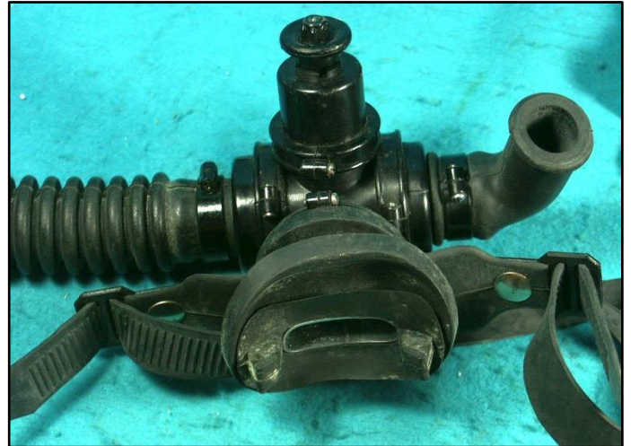
Verschließbares Mundstück mit Ausatemstutzen von Godel für Commeinhes-Tauchgeräte
